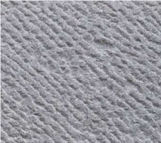
Døme på kvitt granitt som skal brukast i gangsona i Øvre Borggata. Grov rifling i overflata gjev betre feste.
