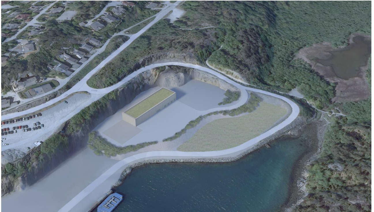
Figur 30 Mogleg plassering av reinseanlegg i Valevågen syner behov for å heve terrenget der reinseanlegget skal ligge til kote +6,5. Taket på reinseanlegget ligg likevel lågare enn vegen bak. Farga firkant til venstre for reinseanlegg syner mogleg utviding til sekundærreinsing.
