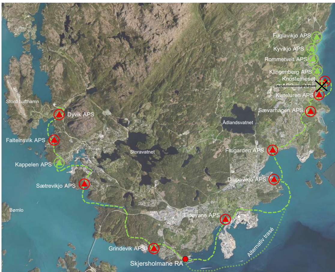
Figur 19: Planlagt overføringsanlegg fram til Skjersholmane er vist med stipla grøne linjer. Raud sirkel er Skjersholmane reinseanlegg og raude trekantar i raude sirklar er nye avløpspumpestasjonar. Grøne trekantar i grøne sirklar er eksisterande avløpspumpestasjonar. Det er utarbeidd ein eigen rapport som viser dimensjonerande avløpsmengder. Teikningsvedlegga KDP-A02 og KDP-A04 viser eksisterande og planlagde avløpsanlegg. For mange av delstrekningane eksisterer det fleire ulike alternative traséar som ikkje er vist på denne skissa. I tillegg er er det fleire eksisterande avløpspumpestasjonar som ikkje er vist på skissa.
