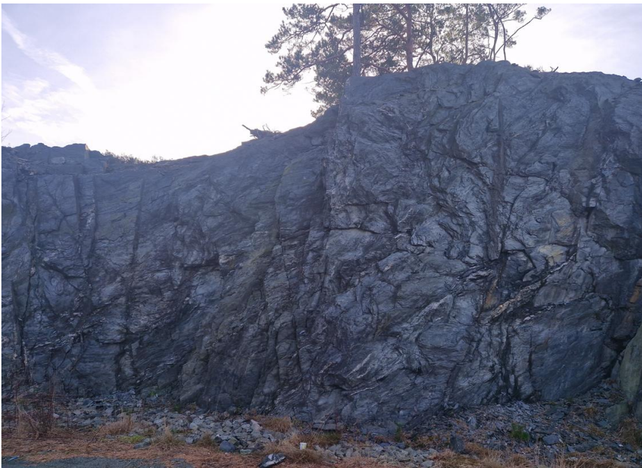
Figur 8: Fylltitten står relativt massiv med steil foliasjon – forvittringsmasser i foten. Blikk i sør-sørøstlig retning.
