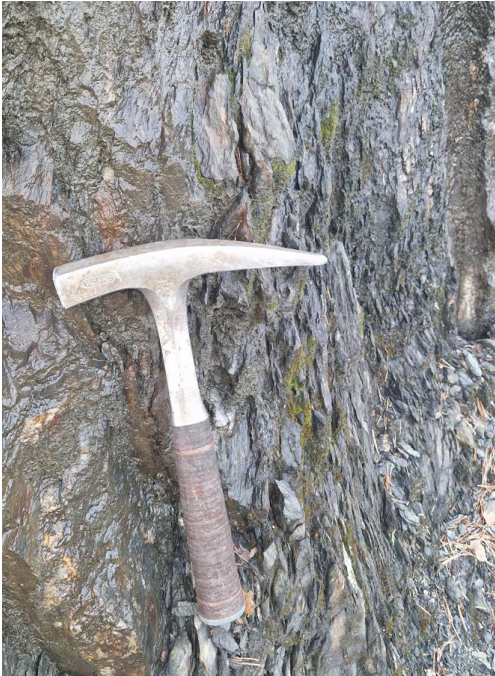
Figur 7: Steil foliasjon i detalj - avflakking av mindre steinplater over tid vil fortsette.
