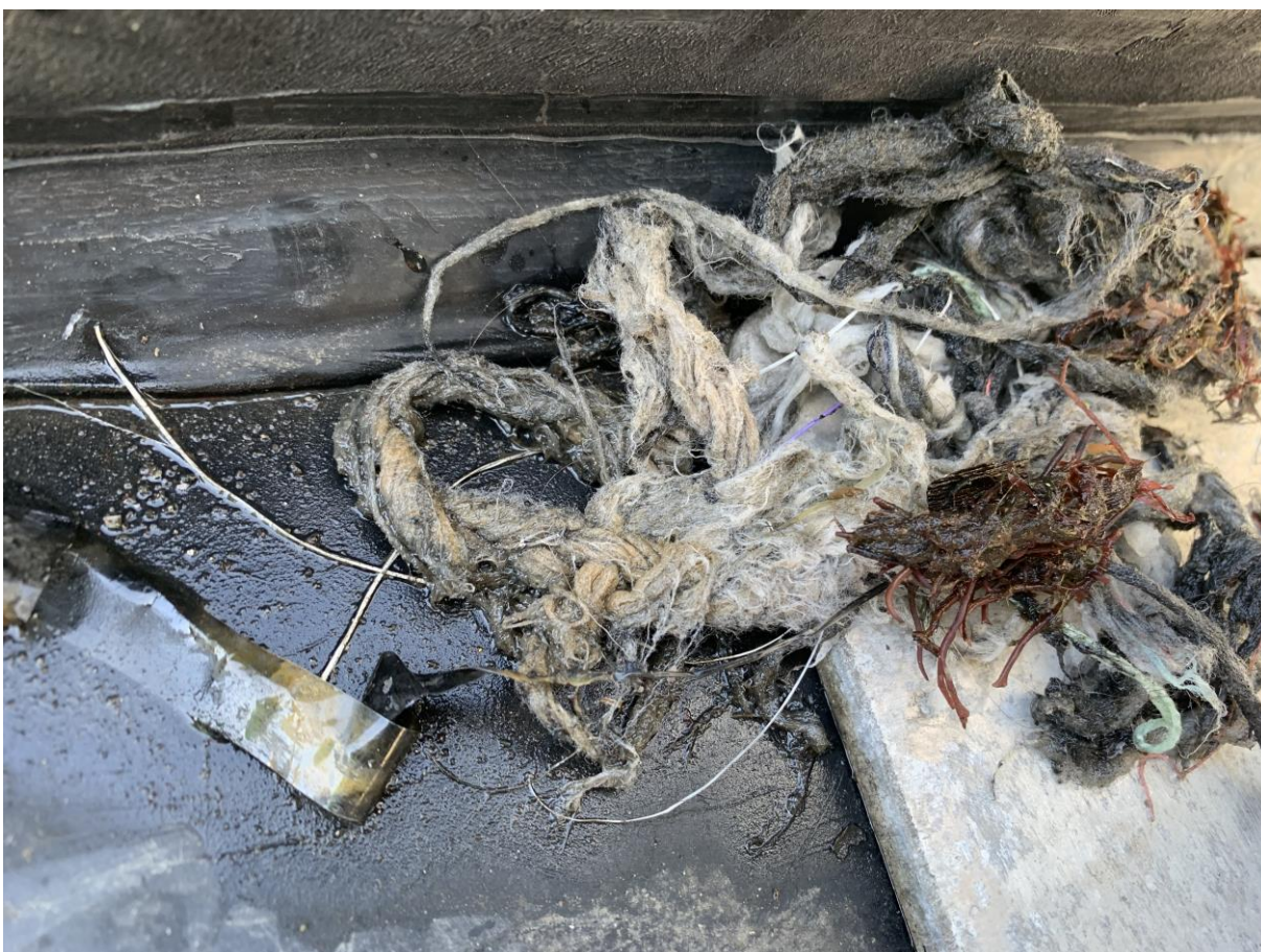
Figur 26. Alger og søppel (trosser, tau, våtservietter/kluter) fjernet fra propeller på ROVen etter undersøkelse av ROV-linjer i nærheten av utslippspunktet fra Lyngneset avløppumpestasjon (se Figur 8 for lokalisering av ROV-linjer). Foto: Subsea Marintech.
