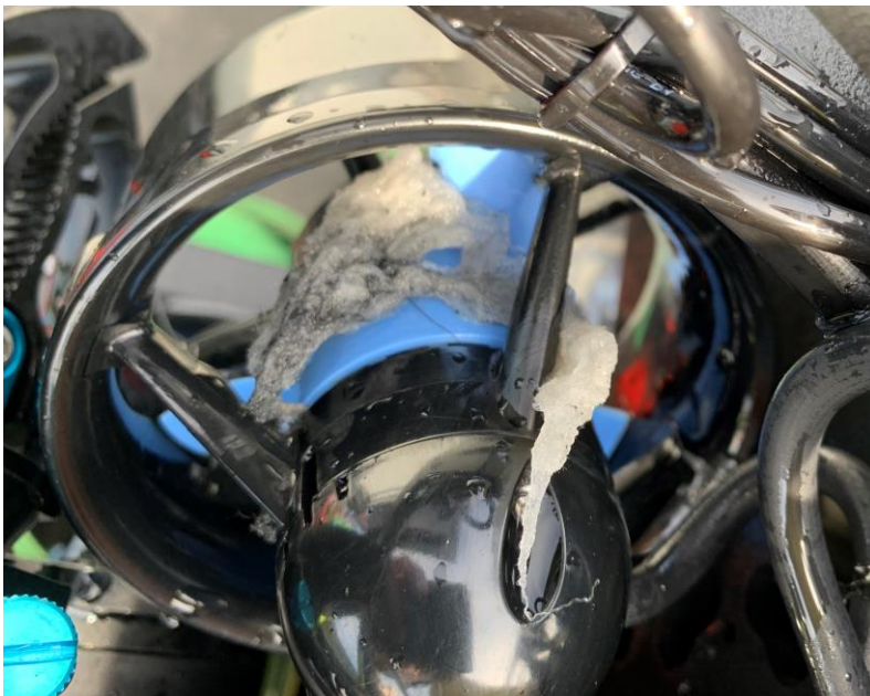
Figur 25. Våtserviett/klut fanget i propeller på ROVen etter undersøkelse av ROV-linjer i nærheten av utslippspunktet fra Lyngneset avløppumpestasjon (se Figur 8 for lokalisering av ROV-linjer). Foto: Subsea Marintech.
