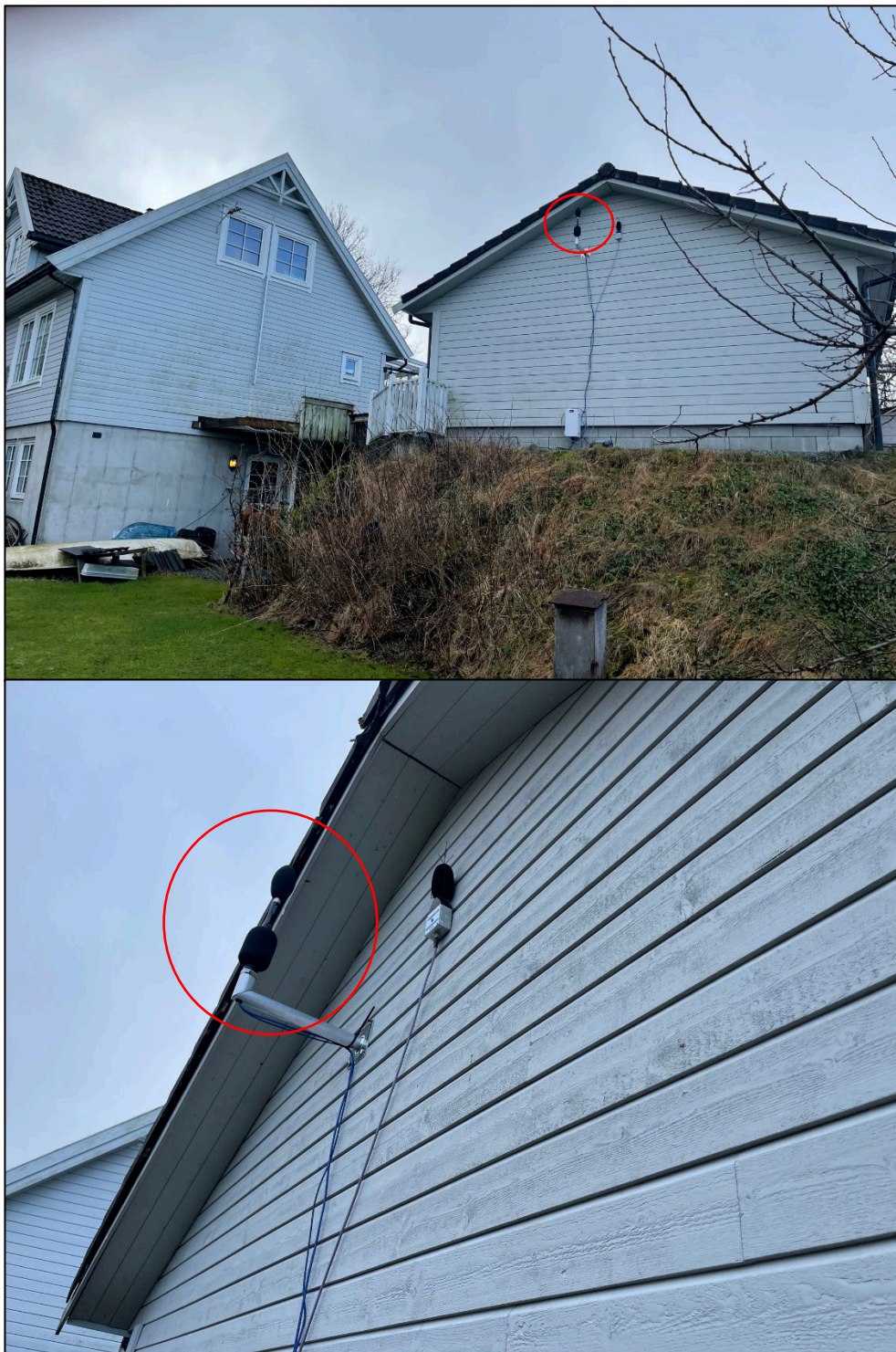
Figur 1-3: Bildene av målestasjon 2 som er montert på den østvendte veggen til garasjen i Kårevikvegen 80. Målestasjonen er markert med en rød sirkel. Bildene er tatt av Norsonic AS, datert 18.02.2022.
